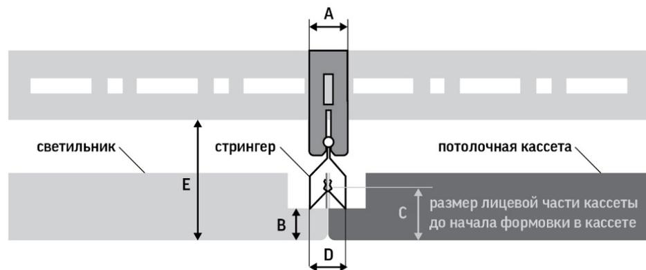
Светильники для кассетных потолков изготавливаются со степенью пылевлагозащиты IP40, IP54 и IP65. Степень защиты оборудования IP54 и IP65 позволяют эксплуатировать светильник во влажных и пыльных помещениях, а также в тех условиях, где требуется изолировать помещение от подпотолочного пространства.
