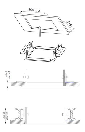
2. Зафиксировать монтажную рамку с помощью винтов в нише потолка, подвесить светильник к монтажной рамке с помощью цепи и карабина и подключить питающий провод к клеммной колодке кабельного соединителя в соответствии с указанной полярностью.
